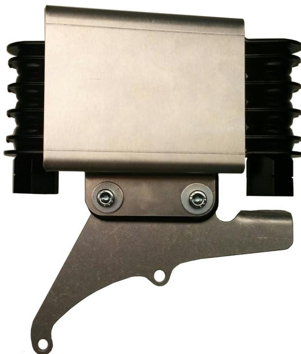
Die Montage des Ölkühlers erfolgt auf der linken Fahrzeugseite oberhalb des Lichtmaschinendeckels mit der hinteren Zylinderfußschraube und mit den mit dem Halteblech korrespondierenden Lichtmaschinendeckelschrauben. Die drei originalen Schrauben können weiterverwendet werden.
