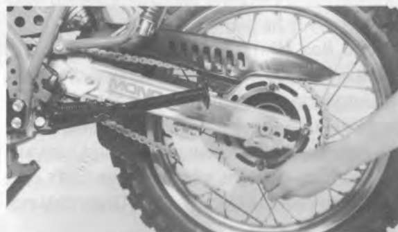
1. Einsteller 2. Bremsstange 3. Splint 4. Achsmutter 5. Hinterradschwinge-Endschraube
