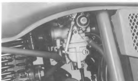
1. Drosselanschlagschraube
