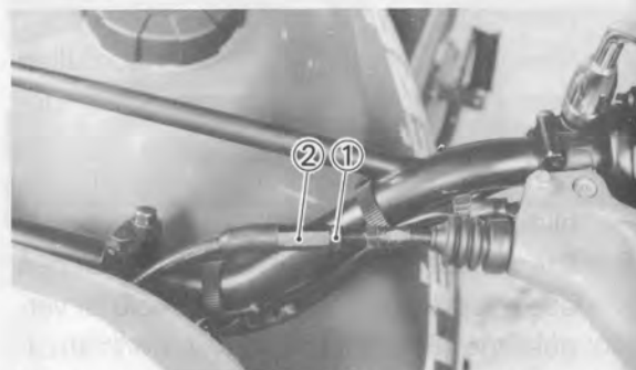
1. Sicherungsmutter 2. Einsteller
