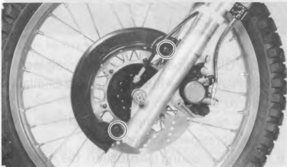
1. Geschwindigkeitsmesserwelle 2. Splint 3. Achsmutter
