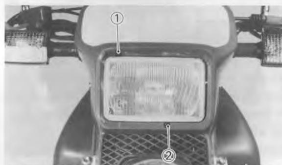
1. Horizontale Einstellschraube 2. Vertikale Einstellschraube
