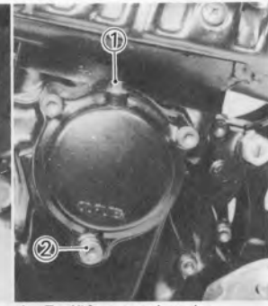
1. Entlüftungsschraube 2. Filterdeckelschraube
