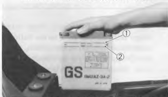
6-42 1. Obere Standmarkierung 2. Untere Standmarkierung
