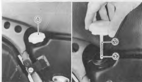
1. Öleinfülldeckel 2. Höchststandmarke 3. Tiefeststandmark
